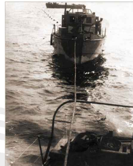
Траление немецких магнитных и акустических мин на Неве. «Двойная тяга» – головной КТЩ-16 и ведомый КТЩ-124, вдаль – электромагнитный трал-баржа. Март-апрель 1944 г. (Фото А.Д. Суника)
